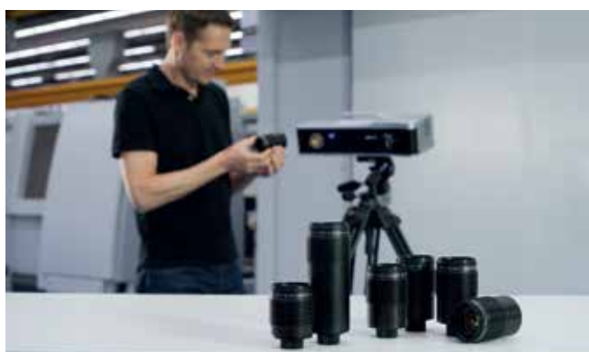
Il sensore giusto per ogni applicazione: Rapida personalizzazione del campo di misura (45 – 500 mm) cambiando semplicemente l'obiettivo
