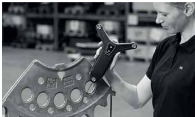
Il tastatore portatile T-POINT di ZEISS, la macchina di misura a coordinate portatile ideale per misurazioni di singoli punti
